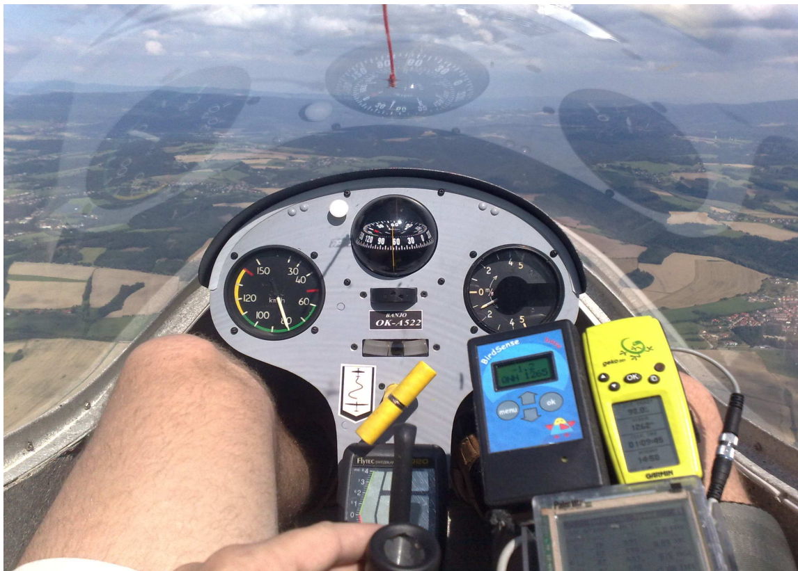
Moje nádobíčko. Akustické vário BirdSense, GPS Garmin Geko 201 a Palm Ille, vše upevněné suchým zipem ke kolébce, kterou mám připoutanou na noze. Někde za hlavou mi tiká Báro. (Tentokráte za letu s Banjem.)
